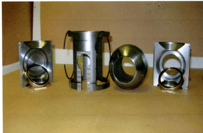
Рис.2 Основные узлы трёхходового шарового крана
